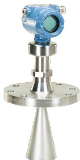
罗斯蒙特 5408C 是一款两线制非接触式雷达变送器，用于各种液体和浆料的物位测量。它采用基于调频连续波原理的独特节能雷达技术，即使在具有挑战性的条件下也能确保可靠的测量效果。
